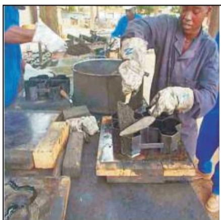
Photos 1 à 4 : Tri des matières premières, chauffage du mélange, moulage, démoulage (Source: Recyclage des déchets plastiques, Fiche no 11, ProGeCo | ReCoMaP)
