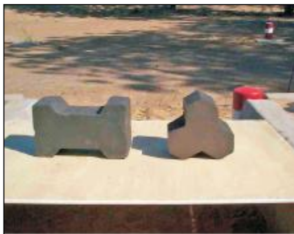
Photos 1 et 2 : exemples de pavés réalisés à partir d'un mélange sable/plastiques (Source : Recyclage des déchets plastiques, Fiche no 11, ProGeCo | ReCoMaP)
