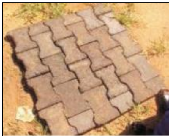
Photos 1 et 2 : exemples de pavés réalisés à partir d'un mélange sable/plastiques (Source : Recyclage des déchets plastiques, Fiche no 11, ProGeCo | ReCoMaP)
